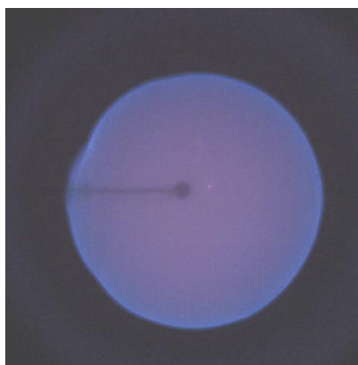
Рис. 2. Распространение пламени в стехиометрической смеси \text{CH}_4 + \text{воздух} . T = 540^\circ\text{C} , P = 1 атм, U = 12 кВ.
