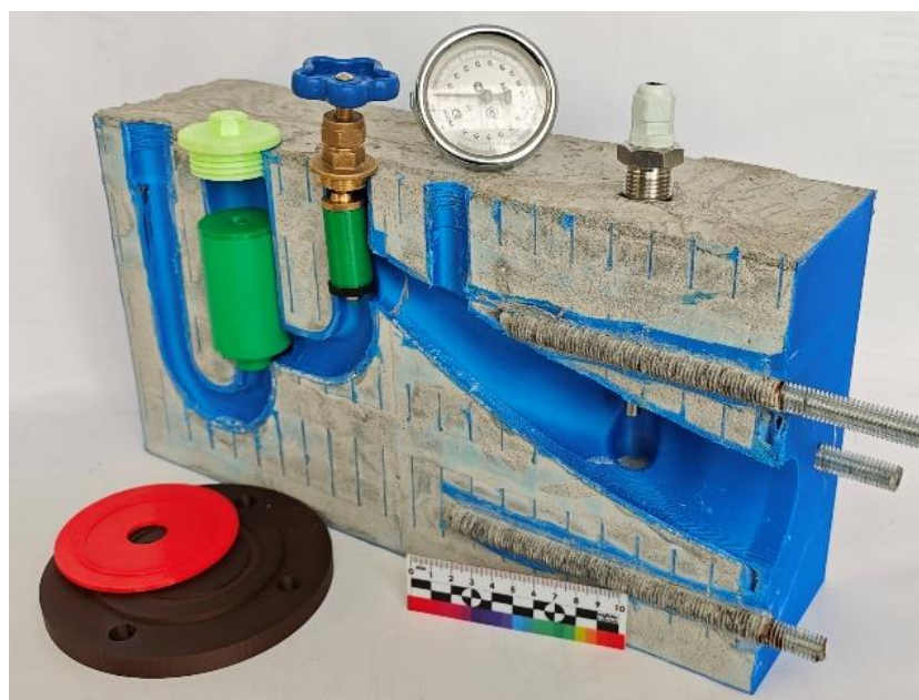
Рис. 2. Моноблок узла трубной обвязки в разрезе.
